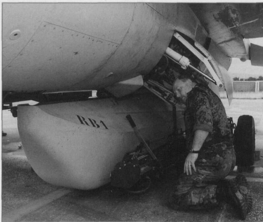
Een Belgische luchtmachtmilitair druk in de weer met de bevestiging van een MARS-pod aan een RF-16 op de Italiaanse vliegbasis Amendola tijdens operatie Allied Force (Bron: Sectie Luchtmachthistorie, Staf BDL)
