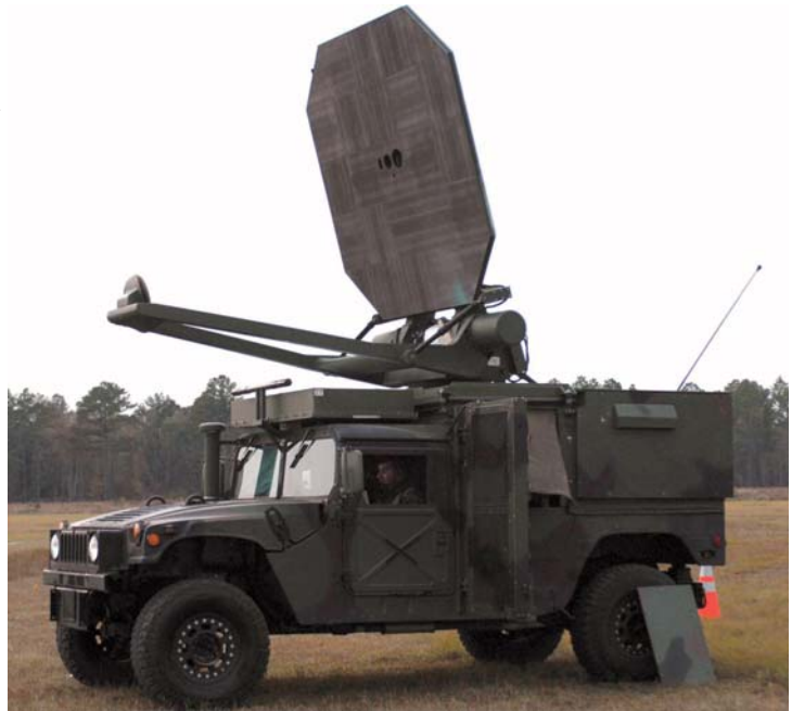
Het niet-letale active denial system veroorzaakt een ondraaglijke hitte op de huid
